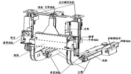
(3)掘锚护截割臂的液压系统,在掘进机原有系统的基础上增加了一套控制系统和执行机构。
